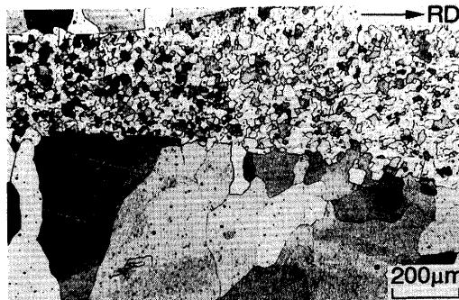
図13 19Crフェライト系ステンレス鋼の柱状晶材の再結晶組織(70%冷間圧延→700°C, 12h)
