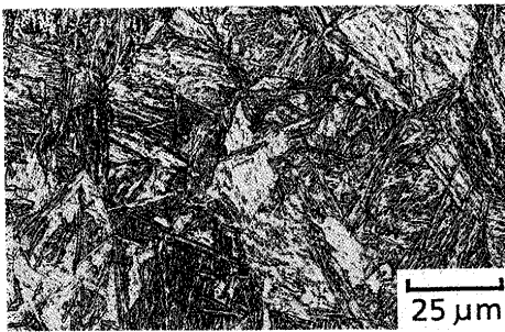
図7 高強度高靱性非調質鋼適用部品の光学顕微鏡組織
