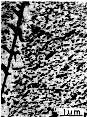
図4 2.25Cr-10Mo鋼中の Fe_2Mo の析出 (873K, 342 MPa, 2810h) 27)
