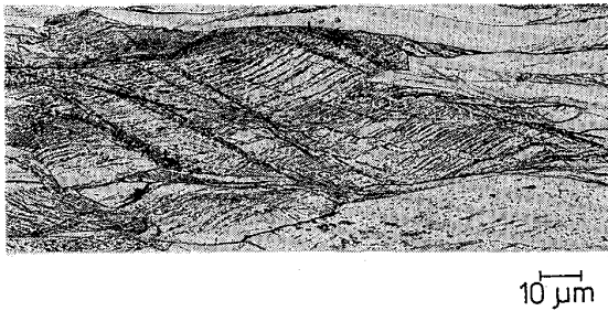
写真 9 炭素が過剰に固溶する高純度鋼で観察された剪断帯
