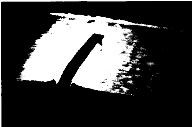
写真 3 Si 基板の引っかき痕
