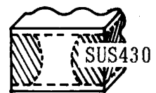
写真1 42Ni-6Cr-Fe/SUS430/42Ni-6Cr-Fe 三層クラッドの塩化第二鉄エッチング後の断面 (リードの先端観察)
