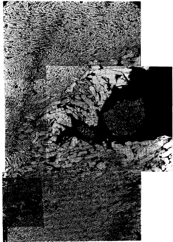
写真 2 Hard \alpha -Type I (Ti-6Al-4V) (倍率×50)
