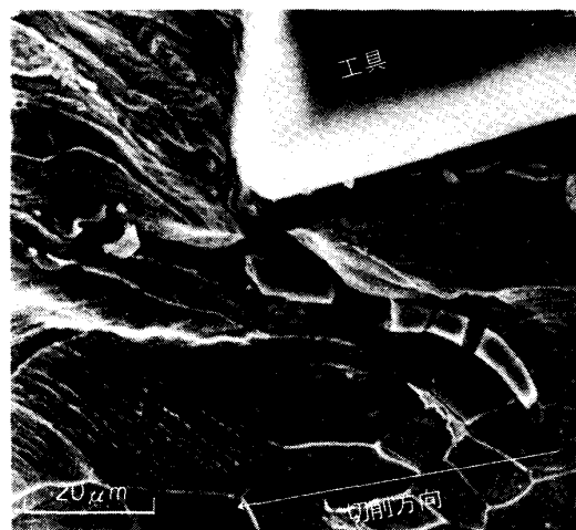
写真 4 長楕円体状 MnS 介在物の挙動 (MnS 形状以外の切削条件は写真 3 と同じ)
