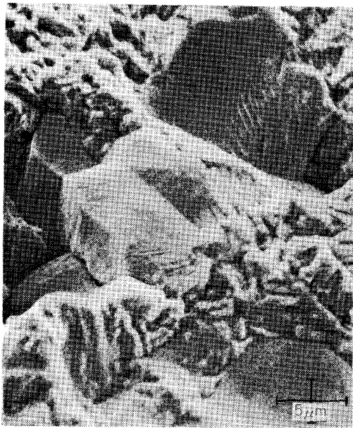
写真13 粒界疲労破面 (炭素鋼)
