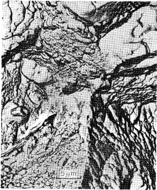
写真12 粒界延性破面 (2219アルミニウム合金, PELLOUX 3) )
