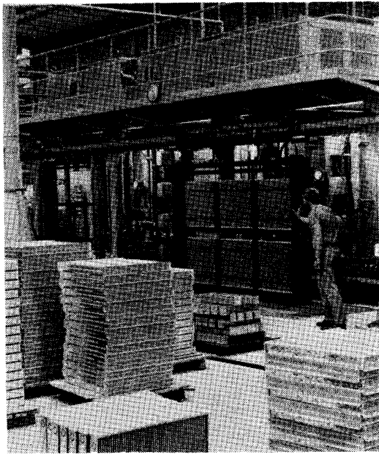
写真 1 英国 I.M.I. 社に設置された真空ろうづけ炉（熱交換機用）の装入部
