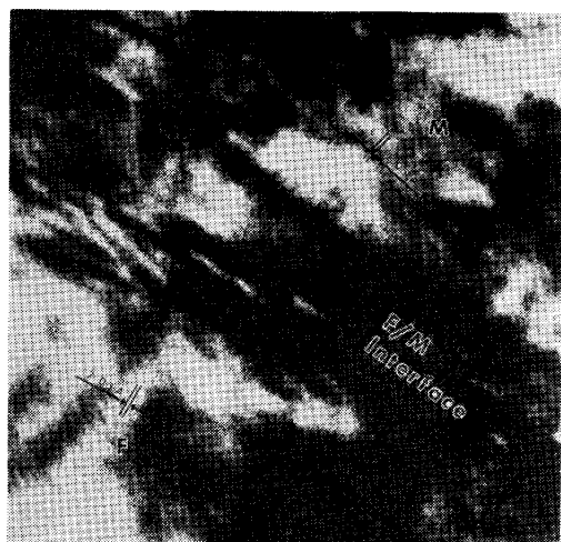
写真 6 二相鋼のフェライト/マルテンサイト境界近傍領域の格子像 90)
