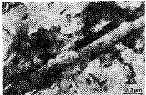
写真 3 600°C で 1000h 時効した SUS 304 ステンレス鋼の粒界近傍の Cr 欠乏層およびフェライト 13)
