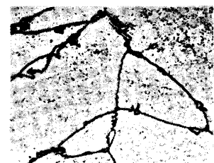
(c) Laser, post anneal (810 °C x 1 min, A.C)
