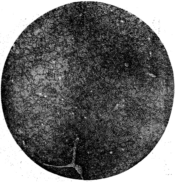
實驗番號 LXXIV (300 倍) 熔融番號 36 銅 9.020 炭素 0.311 1000°C = 五分鐘保チ水中健淬
