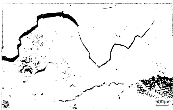
写真2. 鋳片表面横割れの光学顕微鏡組織
