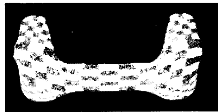
写真1 粗形鋼片メタルフロー
