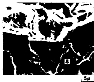
写真2. サブグレインを含む組織と脆性破面の同時観察像
