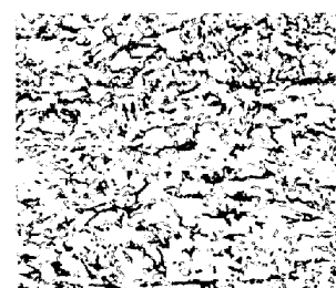
写真2. 本実験のラインパイプ (アシキュラーフェライト組織) 25μ
