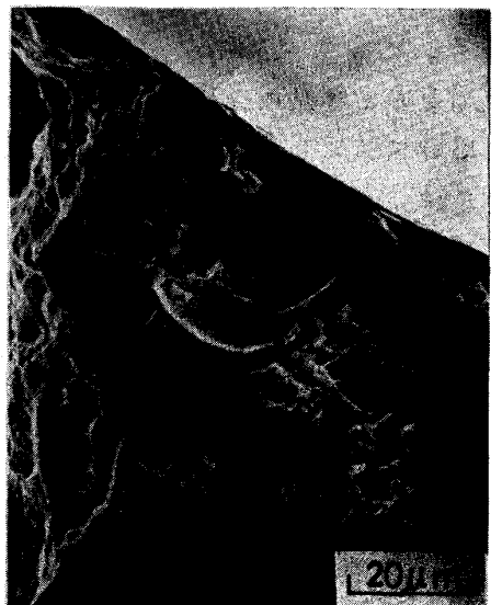
図2 起点部の腐食ピット(江原ほか 4) ) 3×10 -2 % NaCl水溶液 σ=183MPa, Nf=5.1×10 7
