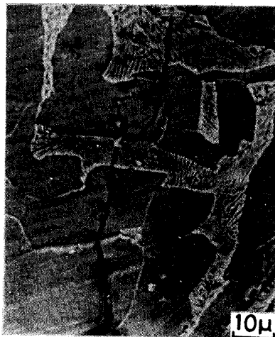
写真1 リムド鋼SS41(5%冷間加工材)の応力腐食割れの走査型電子顕微鏡観察(粒内割れ)
