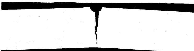
写真1. 水中H 2 S濃度3ppmで発生したSSCと破面(試験片のカタサ:Hv397)
