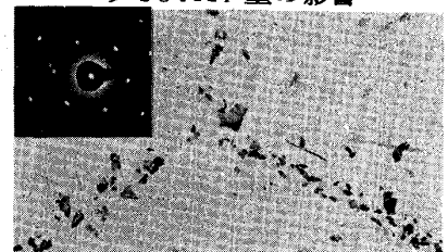
写真1. SR中に生成するSiMnN 1) (solAl トレース材)
