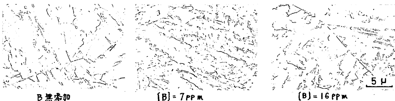
写真1. 固溶B量の異なる溶接ボンド部の電子顕微鏡組織
