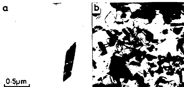
写真2 25Cr-28Ni-8Mo鋼 a) 0%P, b) 0.3%P 1250°C 30min → 800°C 4h 直接焼入時効
