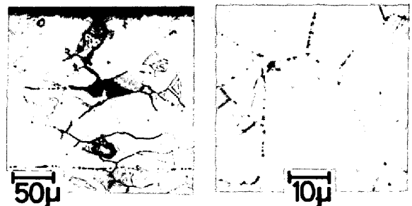
写真1 304鋼の高入熱量溶接材に生じた応力腐食割れと粒界炭化物析出状態
