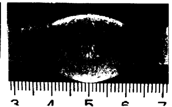
写真1. 溶接継手マクロ組織
