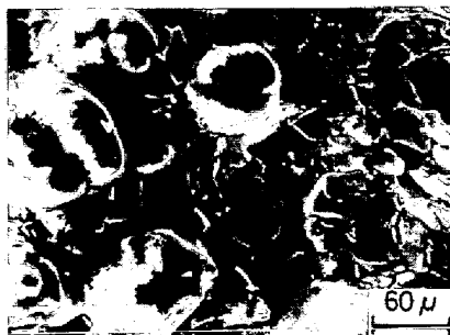
写真2. 探傷図形A部にみられるデンドライト組織および板状サルファイド
