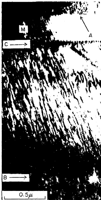
B: 液体窒素に冷却してマルテンサイト変態したときの \gamma - \alpha' 境界 C: 次に室温に上げて逆変態してからの \gamma - \alpha' 境界
