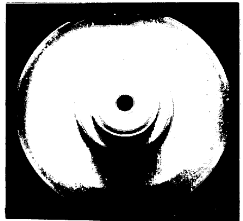
写真1. 高周波焼入試験片におけるクラック伝播状況の一例
