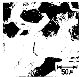
写真2 破面の電顕写真 750°C×600sec f_c=0.76\mu\text{m} 0.9 kgm/cm 2
