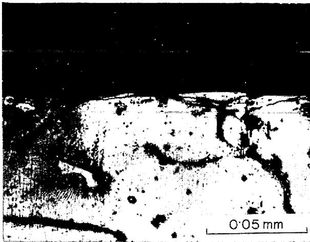
試験片; Stator ねずみ鋳鉄 (550°C 焼なまし) 摩耗条件; p 20kg/cm 2 , v 3.90m/sec, l 500m
