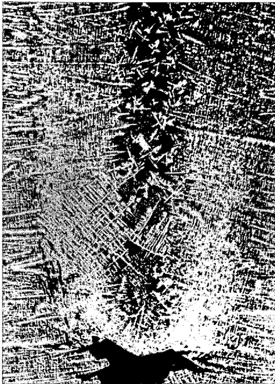
写真5 プリッジ部付近のマクロ組織
