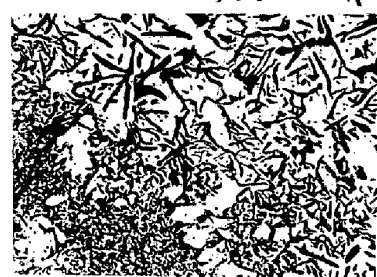
c) 片状黒鉛と共晶状黒鉛が存在する場合の片状黒鉛鉄の組織
