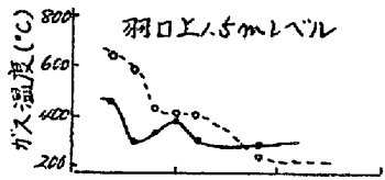
図1. 衝風エネルギーがガス流れに及ぼす影響(羽口前通気性良)
