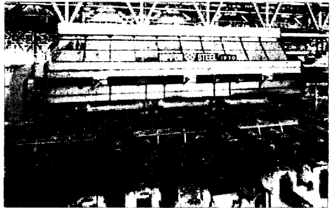
写真 4 スプレー式スラブクーラー
