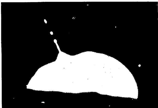
写真4 酸素気流中で浮揚させた鉄-炭素合金滴の破泡につづく液の放出 18)
