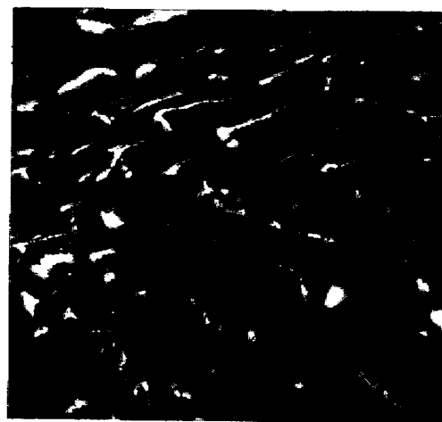
写真 1. 特徴的な水素脆性破面の一例
