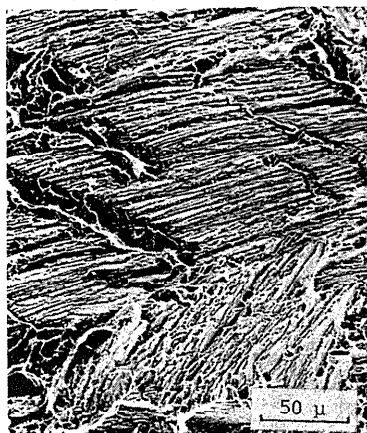
写真1 高温溶体化材のシャルピー破面
