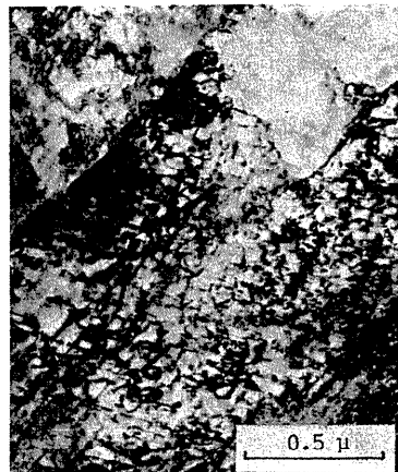
写真2 高温溶体化材のマルテンサイト下部組織
