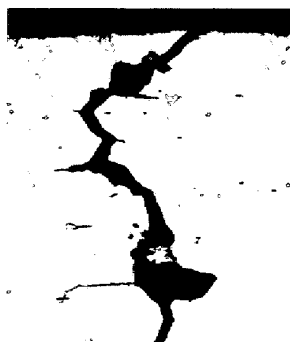
図2 高温高压水でのdouble U-bend法の割れ (×100)
