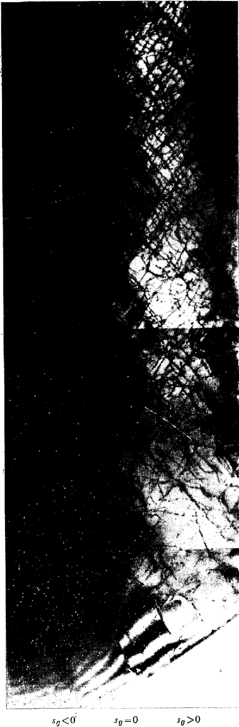
写真1 ベンドコンター(竹の子)付近における転位像。 s_g の符号と明るさ, コントラストに注意. Fe-3%Si 単結晶, 加速電圧 500 kV, (200) 反射。
