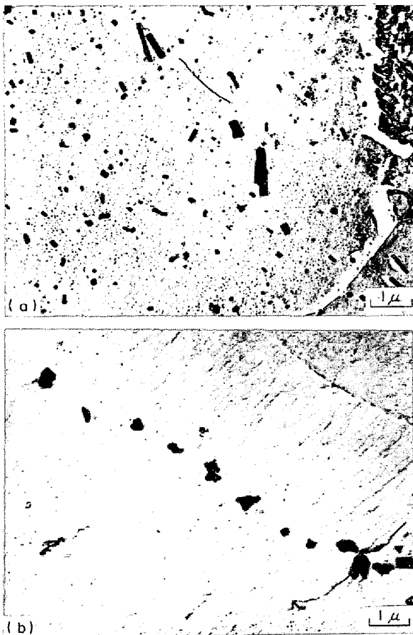
写真 2 45) 含 AlN 鋼中に析出した AlN の抽出レプリカによる電子顕微鏡写真 (a) \alpha 域で析出した AlN (b) \gamma 域で析出した AlN (連続して一次オーステナイト粒界に析出)
