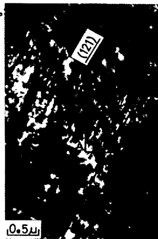
写真3. 1.11% C 鋼における \theta -炭化物析出 (375°C, 1時間焼戻) ○フェライト ● \theta -炭化物
