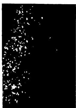
図11. 規則格子反射を用いた暗視野像。
