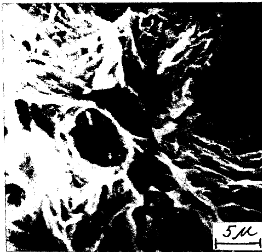
写真 4 R.Q. 処理したまの S 鋼の破面の中心部
