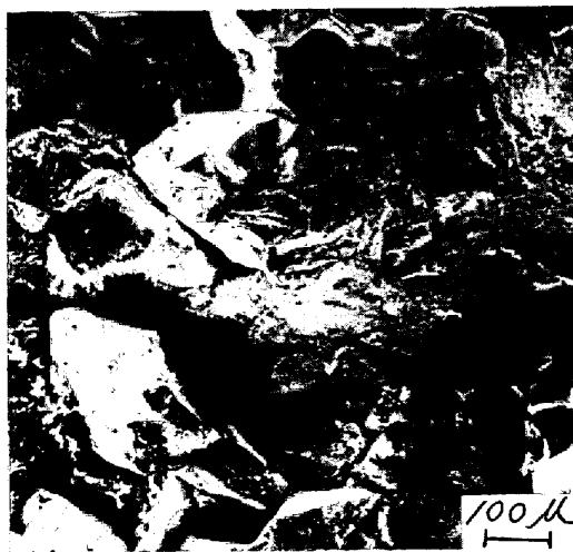
写真 8 850°C x 2hr 時効した K4 鋼の破面の中心部
