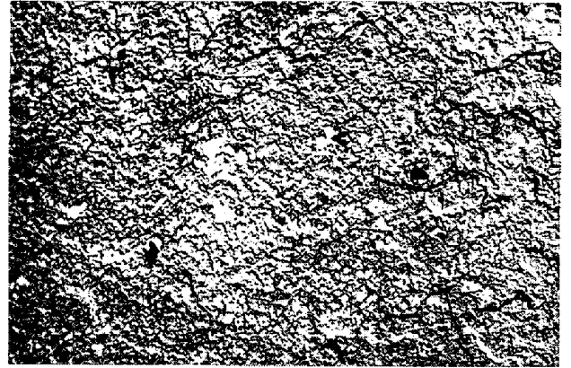
写真 10 475°C 600hr 焼き戻したマルエージング鋼，-196°C 引張破断
