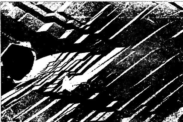
写真16 工業用純 Ni, 650°C 長時間保持による脆化. 20°C 引張による粒界破壊
