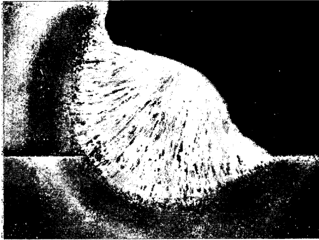
写真1 JIS SM53級鋼材T形すみ肉継手におけるヒールクラックの例
