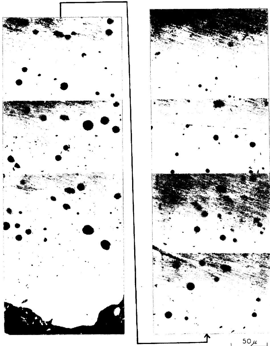
Photo. 6. Precipitates in Mn-O-Fe (d) alloy after annealing at 1450°C for 5hr (Slag : FeS).
