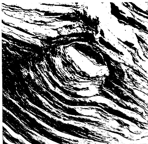
Photo. 3. 鋼 (UTS : 29 kg/mm 2 ) の繰返し曲げ疲れ破面に見られた介在物と Striation 45) . 2 × 10 4 で破壊。
