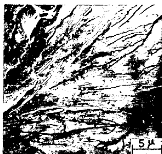
写真2 焼もどし上部ベイナイトの脆性破面
