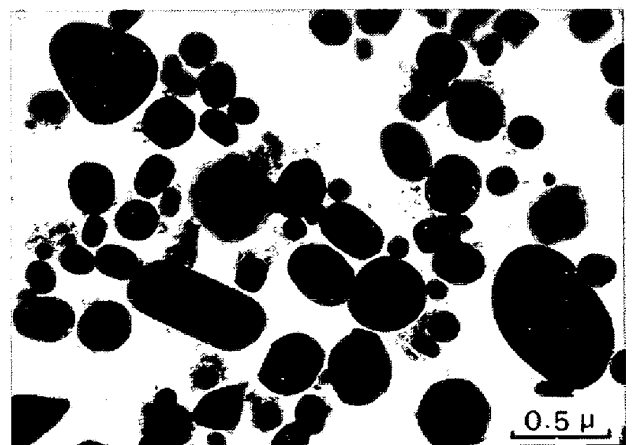
写真 3 Fe-0.5%Nb-0.03%C 鋼 (970°C×1hr, 図 2 の c) から 6N 塩酸室温静置溶解法によって抽出分離した炭化ニオブ
