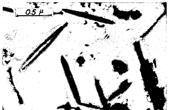
写真1. 3Fを600℃恒温変態(1hr)させた時の析出物(透過電顕)
